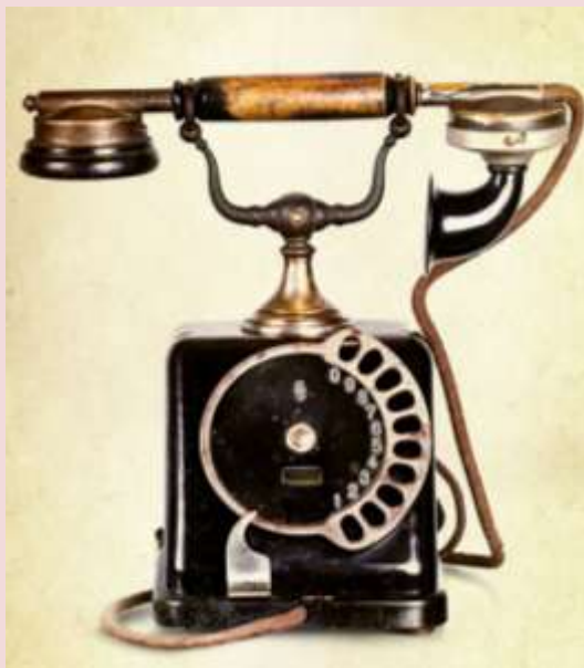
Аппарат с наборным механизмом. Имеет номеронабиратель в виде диска с обозначенными цифрами. Диск назвали «кастет» из-за его внешнего вида. Аппарат имеет микрофонную трубку с угольным микрофоном и поляризованный звонок. Использовался в местах общего пользования в Германии и в других странах Европы. 1910г.
