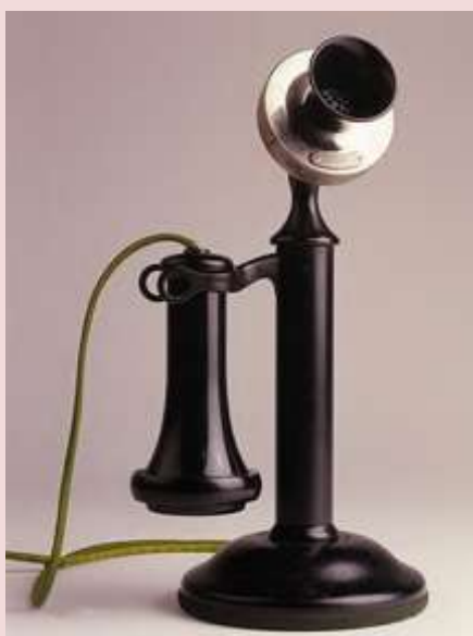
Настольный телефонный аппарат, Дизайн этой модель стал стандарт- ным для настольных телефонов на 30 лет. 1897г.
