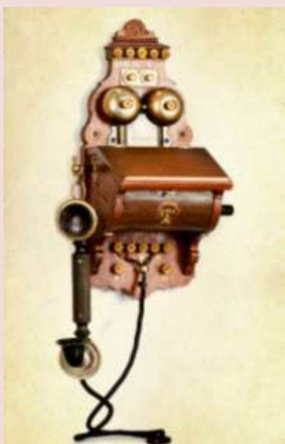
Аппарат с индукторным вызовом без батарейного ящика. Имеет трубку с угольным микрофоном и электромагнитным телефоном на рычажном держателе и поляризованный звонок. Батарея располагается в отдельном ящике. Предназначался для работы в городских сетях. Использовался в странах Европы, в России в начале XX в. 1890-е г.г.
