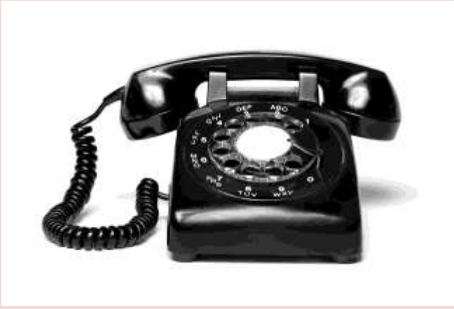
Настольный телефонный аппарат. Модель «500» (1949г.). Полностью обновлен по дизайну, с регулируемым звонком.
